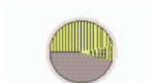
D Rys. D - typowy rozdział światel mijania na szybie rozpraszającej reflektora paraboloidalnego.
