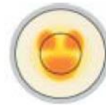
D Rys. D - typowy rozdział światła mijania reflektora typu super DE na szybie reflektora
