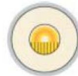
D Rys. D - typowy rozdział światła mijania reflektora typu DE widziany na szybie reflektora
