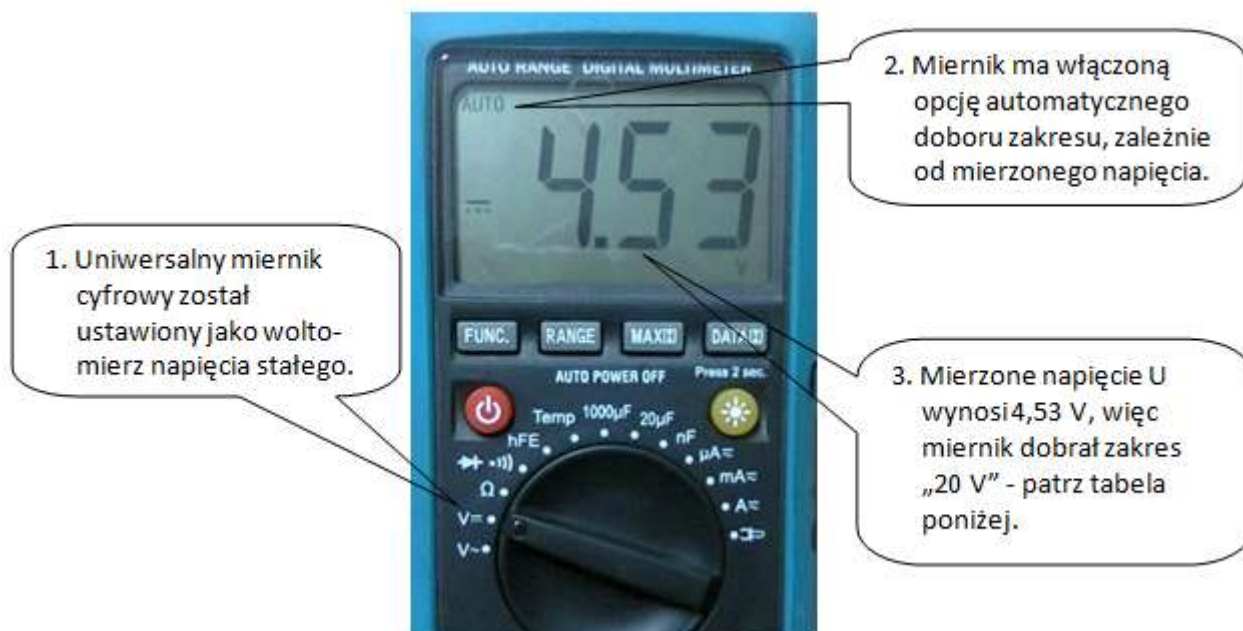
Rysunek 2. Uniwersalny miernik cyfrowy jako woltomierz
