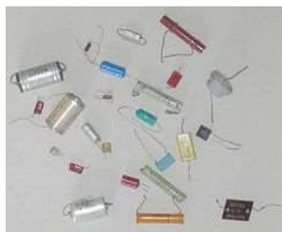
Kondensatory stałe różnych typów i o różnych pojemnościach
