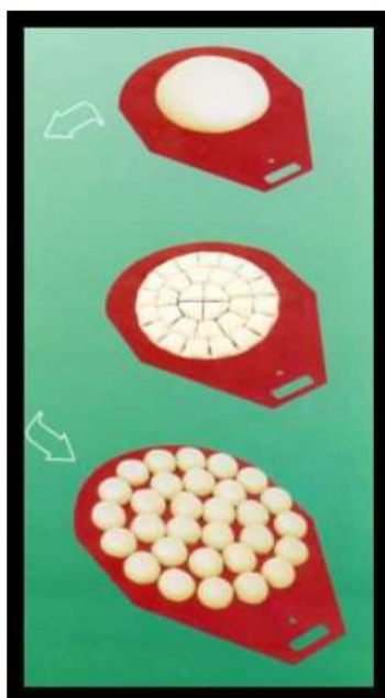
Rys. 16. Kolejne fazy pracy dzielarko-zaokrąglarki: rozplaszczony kęs pierwotny, podzielony kęs pierwotny, kęsy zaokrąglone [www.jeremy.pl]
