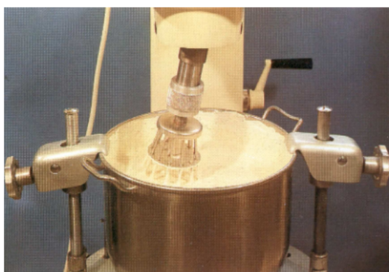
Rys. 10. Ubijarka a) z mieszadłem umocowanym centralnie, b) z mieszadłem planetarnym [9, s. 291]
