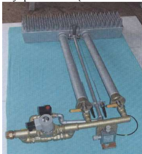
Rys. 19. Palnik gazowy inżektorowy przeznaczony do pieca rurowego [www.palnikigazowe.pl/szczegoly.html]
