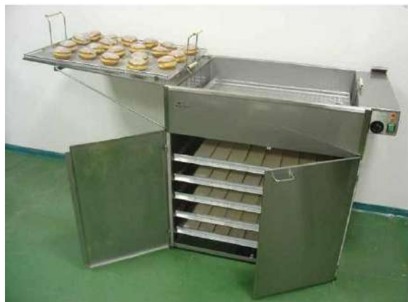
Rys. 31. Smaźalnik o działaniu okresowym z garownikiem (wywrotki w garowniku)
