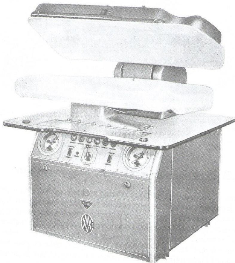
Rys. 12-9. Prasa uniwersalna elektryczno-parowa Csepel Cs 313
