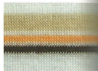
Fot. 2. Trykot – splot podstawowy kolumnikowy
