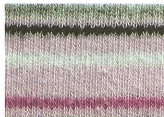
Fot. 3. Interlok – splot pochodny rządkowy
