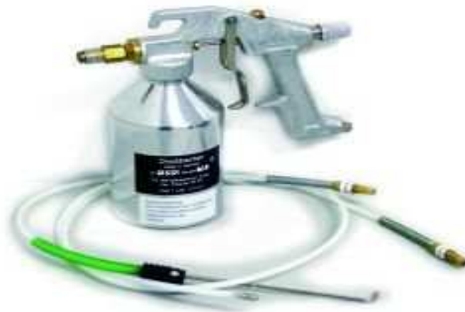
Rys. 23. Pistolet ciśnieniowy z podwieszonym zbiorniczkiem [10, s. 10].
